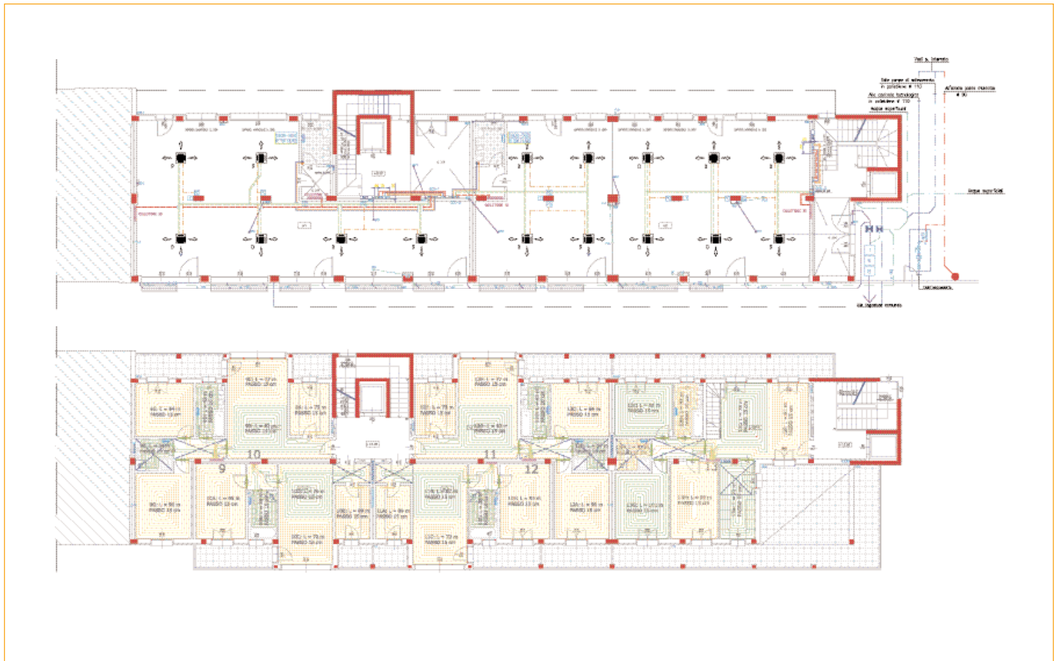
Pianta del piano tipo: impianto di ventilazione meccanica e impianto a pannelli radianti a pavimento.
